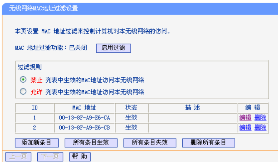
图 5-37 无线网络 MAC 地址过滤设置
