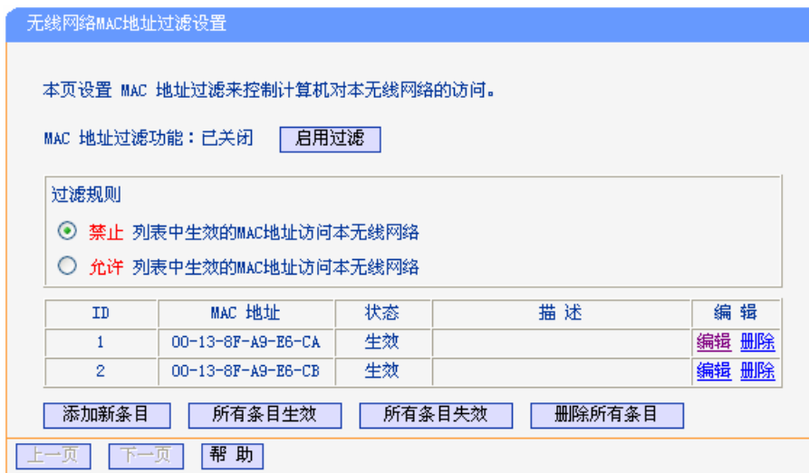
图 5-23 无线网络 MAC 地址过滤设置
